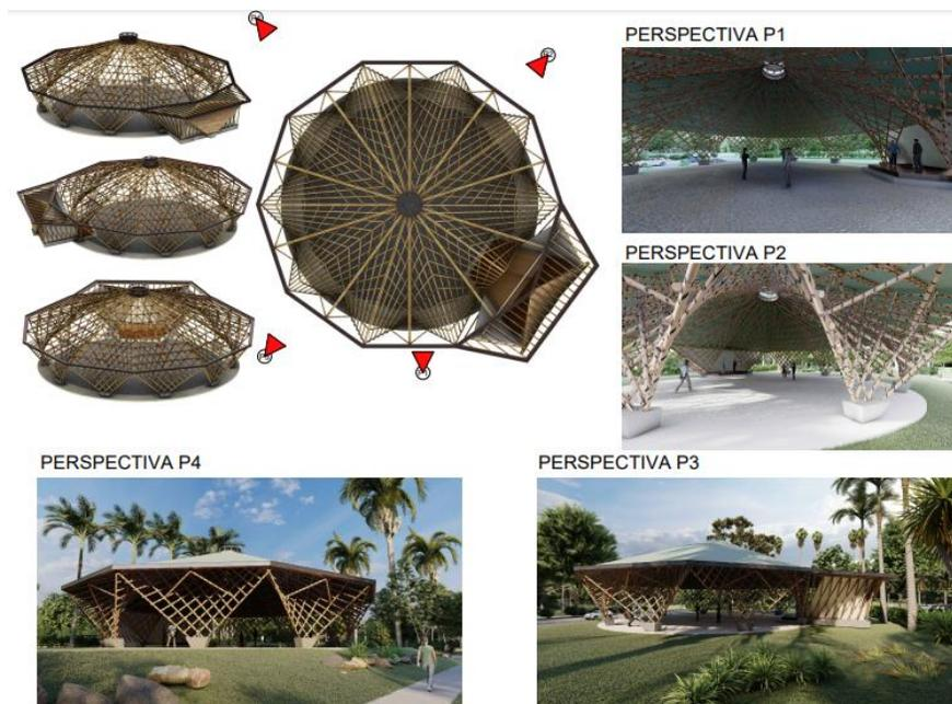
Se pretende la construcción con un área total de 364 metros cuadrados. Se consideraron los elementos determinantes de diseño, como los materiales alternativos de construcción para el presente caso la Guadua. Así mismo, se tienen estudios y diseños detallados de los diferentes componentes necesarios como; Arquitectónico, Estructural, Eléctrico y Plan de Manejo Ambiental, con los cuales se obtiene la información necesaria para su construcción.
